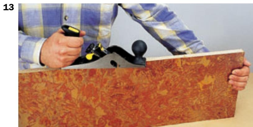
**13. Avec un rabot équipé d'une lame parfaitement affûtée, araser le stratifié le long du chant. Pousser le rabot légèrement en biais.**
