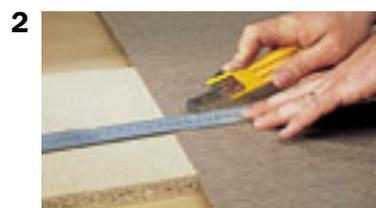
**2. Pour découper le stratifié, utiliser un cutter spécial "à stratifié" (ou une griffe à stratifié) appuyé le long d'une règle. Passer la lame plusieurs fois pour réaliser une rayure profonde dans le dos du matériau.**
