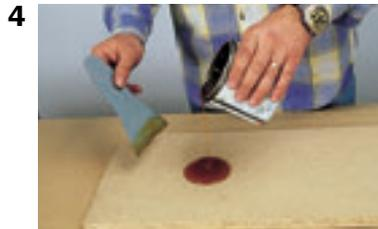
4. Encoller la tablette avec de la colle néoprène. Déposer la colle sur toute la surface avec une spatule à fines dentures.
