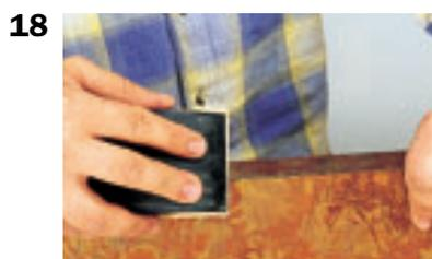
**18. Raser le chant au rabot côté inférieur puis l'affleurer côté supérieur avec une cale à poncer et de l'abrasif fin.**
