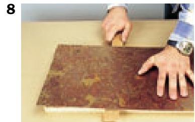
7. Poser le stratifié sur les lamelles. Cette technique permet de positionner le stratifié pour qu'il déborde régulièrement autour de la surface à revêtir.
